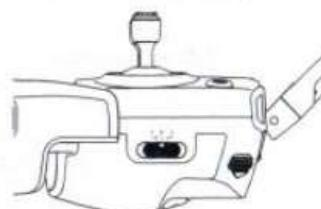
Ve výchozím továrním nastavení je stále nastaven P-režim bez ohledu na polohu přepínače, Mavic 2 Enterprise začíná ve výchozím nastavení v P-režimu. Pro umožnění přepínání letových režimů přejděte na stránku „Camera View“ v aplikaci DJI Pilot, klepněte na ➡️ a zapněte volbu „Multiple Flight Modes“ (Více letových režimů). Po umožnění volby více letových režimů můžete přepnout na P-režim, S-režim nebo na T-režim.
