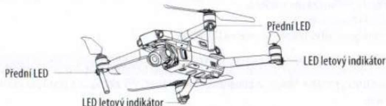
Přední LED ukazují orientaci modelu; po zapnutí modelu svítí nepřerušovaným červeným svitem pro vyznačení polohy přídě (přední LED je možno vypnout v aplikaci DJI Pilot).
